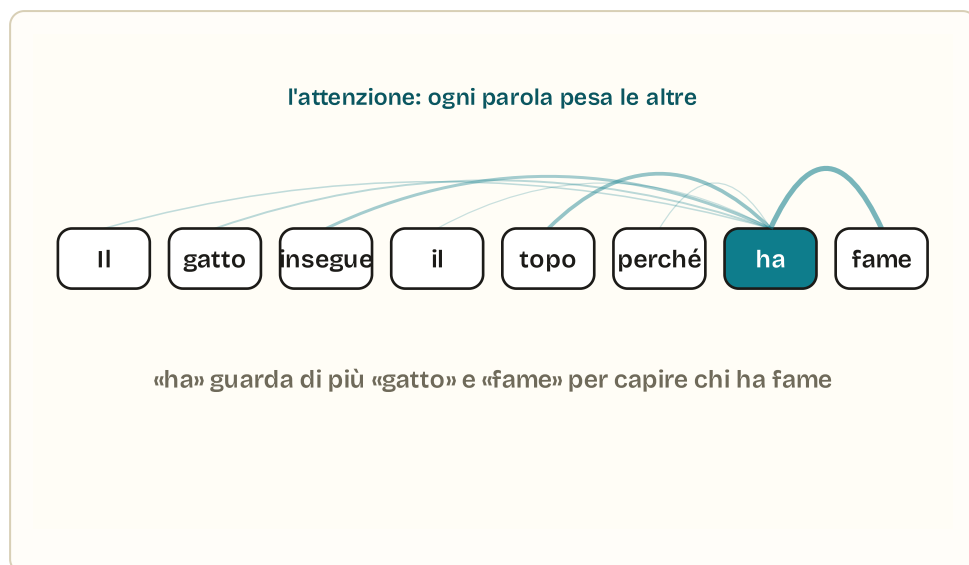
Fig. 9.1. L'attenzione in azione: per dare significato a una parola, il modello pesa tutte le altre della frase. Lo spessore dei collegamenti è «quanto la guarda». È così che disambigua «banca», «ha», i pronomi, i riferimenti.
